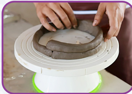
ภาพที่ ๕ ลักษณะวิธีการปั้นแบบหุ้ม และวิธีการปั้นแบบนิ้ว
